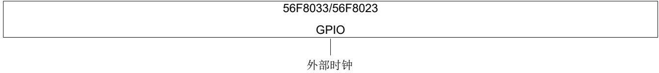
图 3-4 使用 GPIO 连接外部时钟信号
