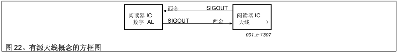
图 22. 有源天线概念的方框图
